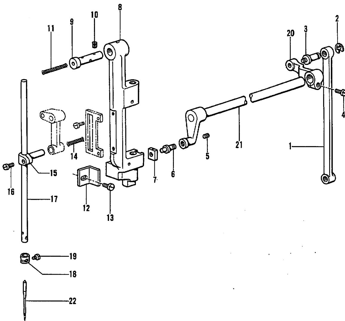
C. 針棒振動関係 /Needle bar rocking mechanism/Nadelstangenbetätigung/
