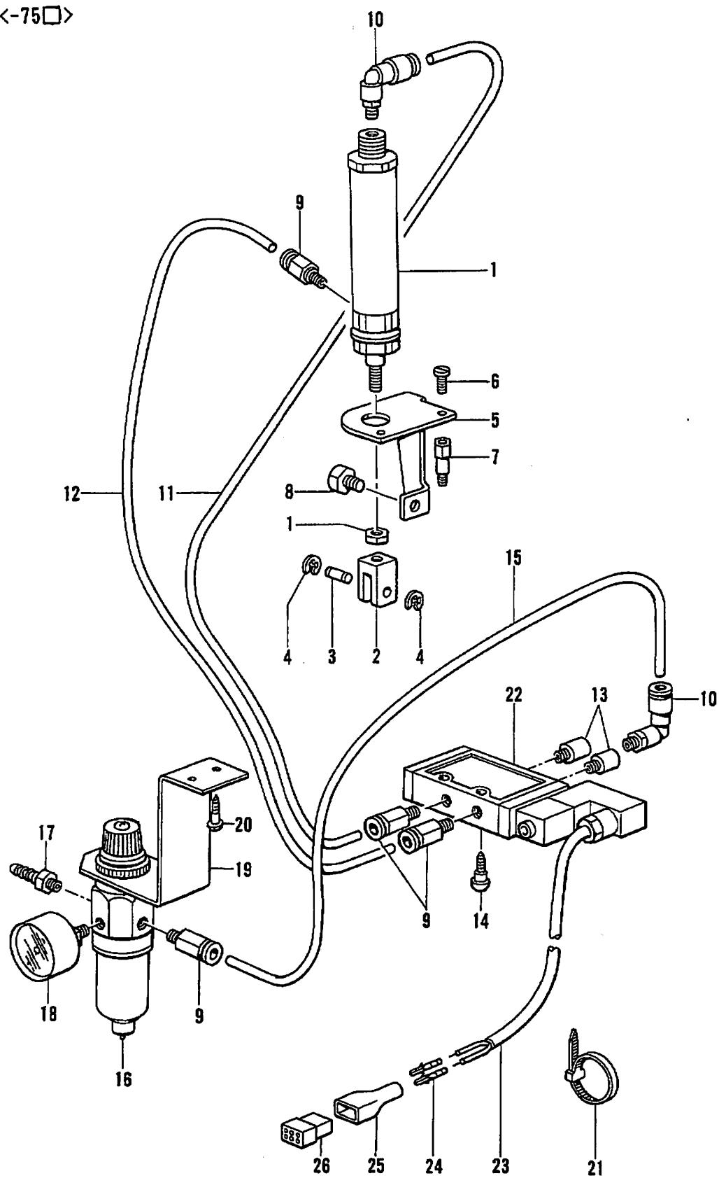
E. 押工上ヶ関係 /Work clamp lifter mechanism/Stoffhalterhebervorrichtung/
