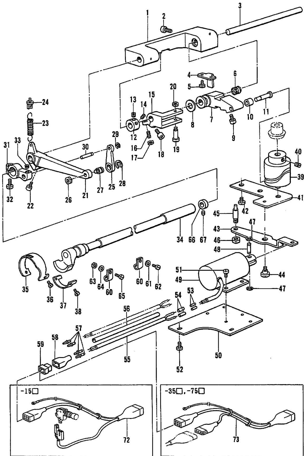
L. 糸切り関係 /Thread trimmer mechanism/Fadenabschneidevorrichtung/
