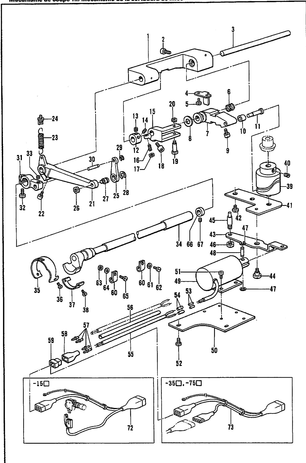
L. 糸切り関係 /Thread trimmer mechanism/Fadenabschneidevorrichtung/
