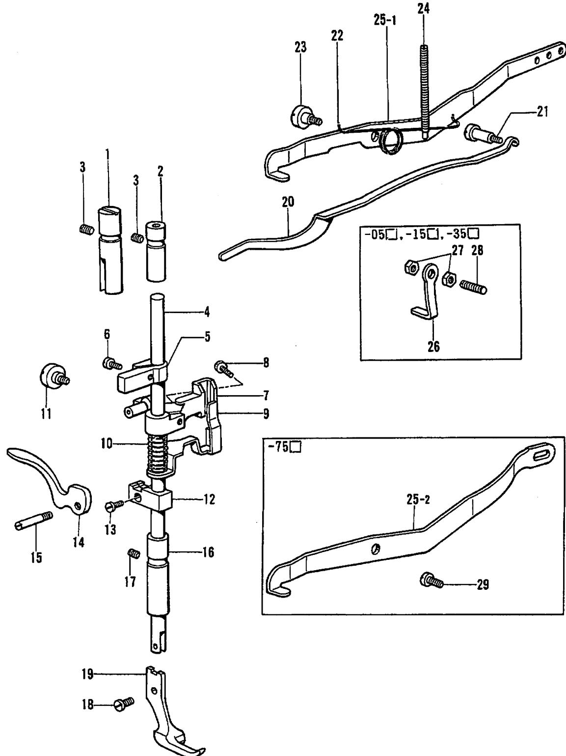
D. 押工関係 /Presser foot mechanism/Stoffdrückerfuß/
