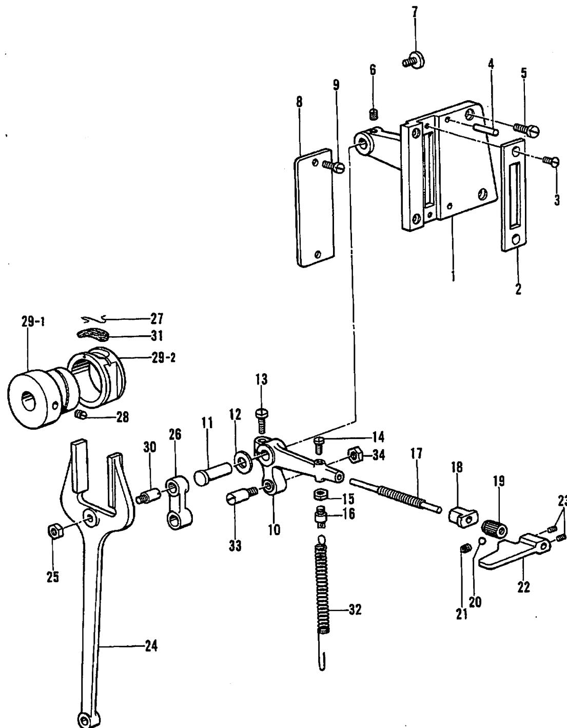
J. バック関係 /Reverse stitching mechanism/Rückwärtsnähvorrichtung/
