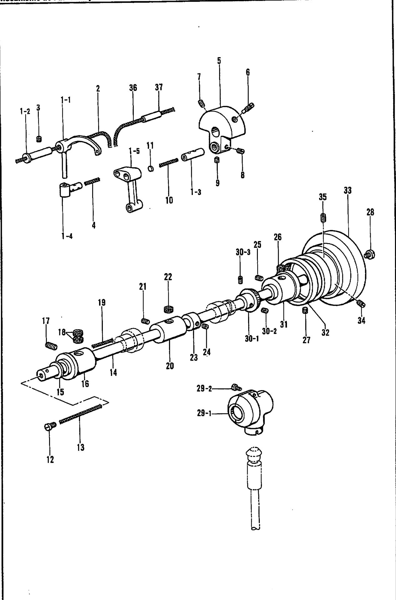
B. 上軸・天ビン関係 /Upper shaft and thread take-up mechanism/Obere Welle und Fadenabnahmeverrichtung/
